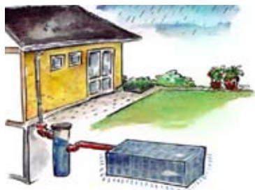
Faskine. En nedgravet kasse som er koblet til tagrenden. Regnvandet opmagasineres i kassen hvor det nedsisver i jorden. Nedsivning i faskine kræver en nedsivningstilladelse.
